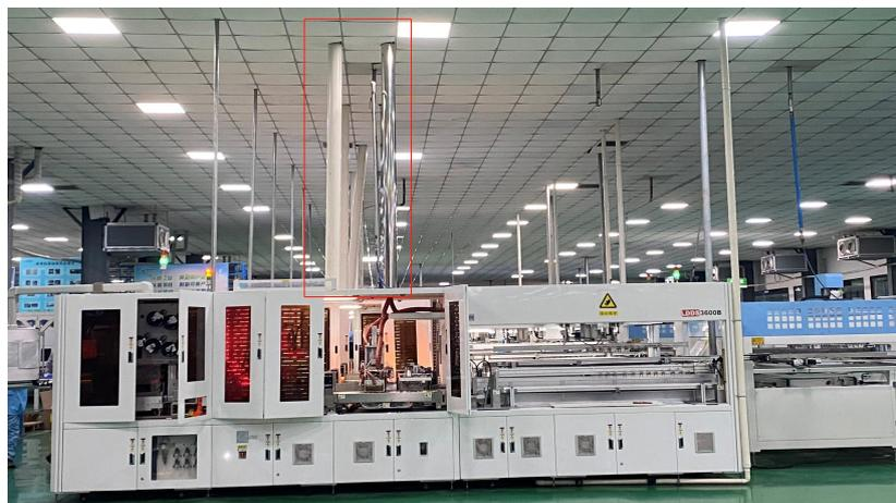
图① 串焊机气体排放管道
